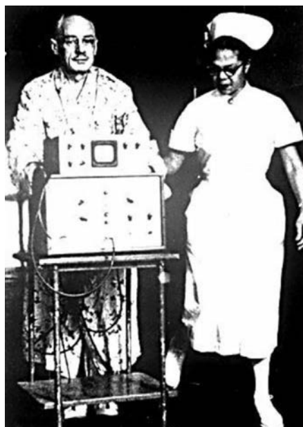
Sistema de estimulación de Zoll, cuyo generador era transportado en un carro.
