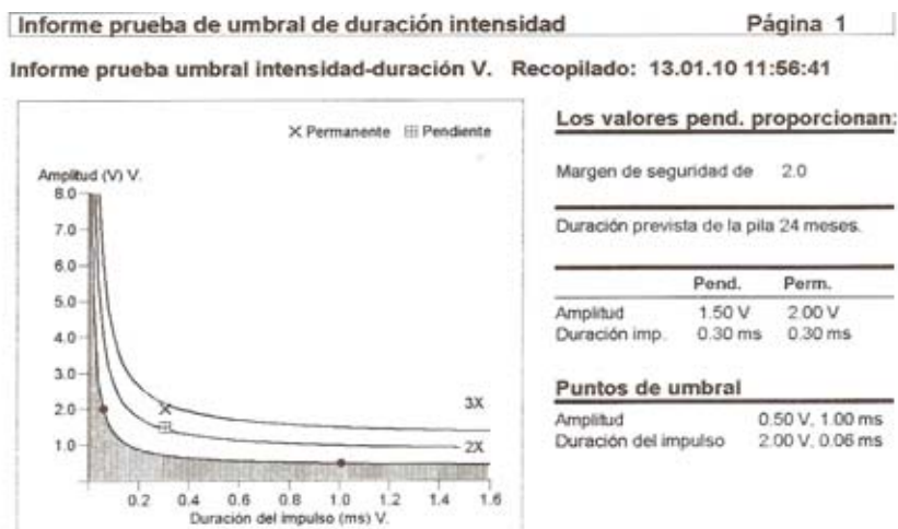
Figura 4. Sistema del programador Medtronic que proporciona una recomendación de programación del impulso. El sistema proporciona una curva voltaje-duración tras la determinación del umbral en voltaje y duración. También muestra curvas para valores del impulso con margen de seguridad doble y triple.
